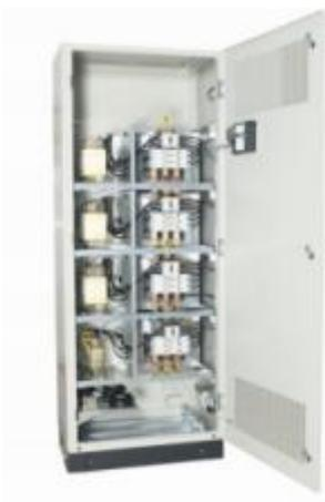
A instalação de baterias de condensadores permite eliminar a parcela energia reativa da fatura de energia elétrica. As baterias de condensadores do tipo Alpimatic Anti-Harmónica Super-Reforçada são equipamentos de compensação automática da energia reativa para redes poluídas.  $50 \% < SH/ST$
